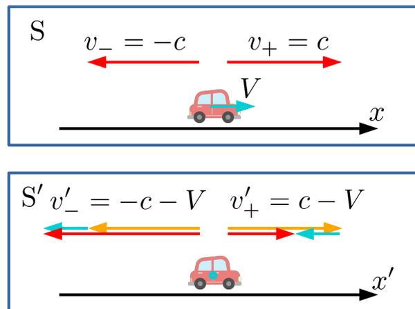
図 4 ガリレイ変換では光の速さが向きに依存してしまう
