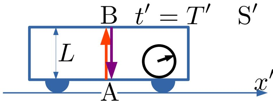
図8  $S'$  で見ると、光は A から射出され天井の点 B で反射され再び A に達する。
