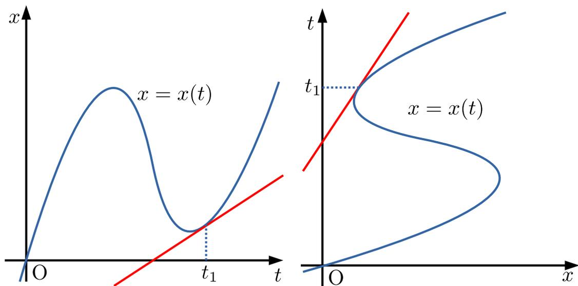
図2 物体の世界線  $x = x(t)$  上の点  $(t_1, x(t_1))$  における接線の傾きを  $\frac{dx}{dt}(t_1)$  と書く。曲線  $x = x(t)$  上の各点においてこれを定めることができるので、各  $t$  に対して  $\frac{dx}{dt}(t)$  と書く。これを  $x(t)$  の  $t$  による微分という。物理では、これは時刻  $t$  における物体の(瞬間)速度  $v$  である。ただし、横軸に  $x$ 、縦軸に  $t$  をとる時空図では接線の傾きの逆数になることに注意。
