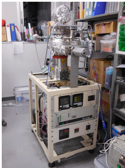
図 11 水素・重水素吸収セル製作システム。
