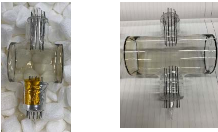
図1. 試作した光路長 60 mm の吸収セル (左) 及び 100 mm の吸収セル (右)。
