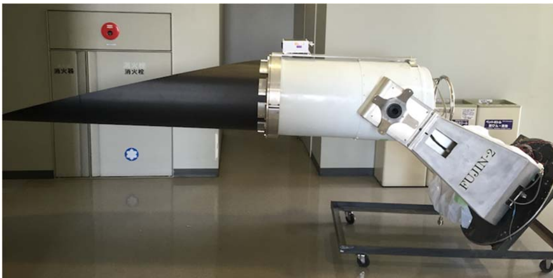
図 5. FUJIN-2 用口径 400 mm カセグレン望遠鏡に CFRP フードを取り付けた状態。
