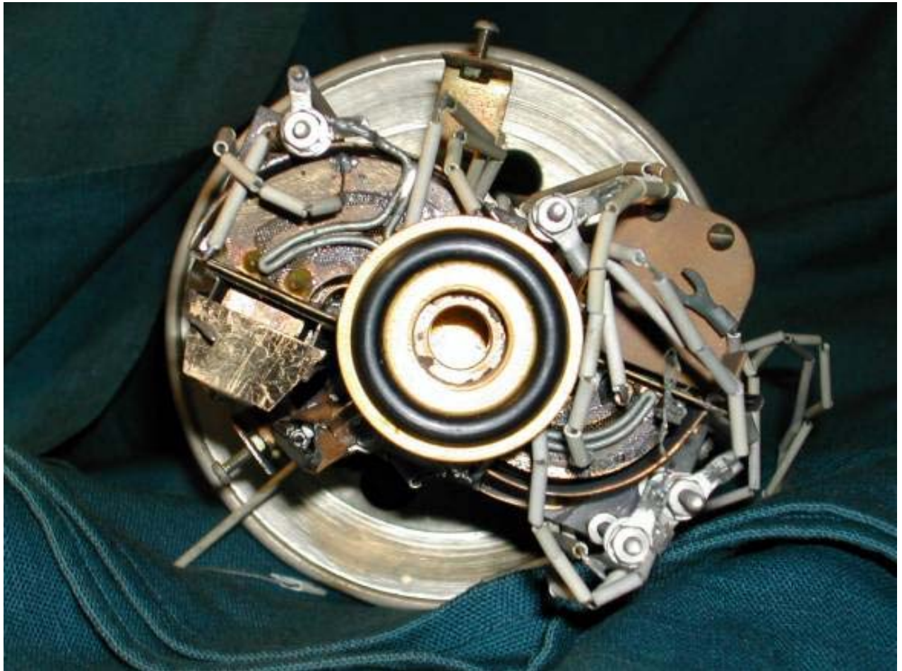
脇谷先生手作りの日本最初の低速電子 用電子分光装置（昭和43年頃）
