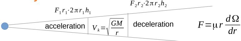
$$\frac{d\Delta m r V_k}{dt} = -F_2 r_2 \cdot 2\pi r_2 h_2 + F_1 r_1 \cdot 2\pi r_1 h_1$$
