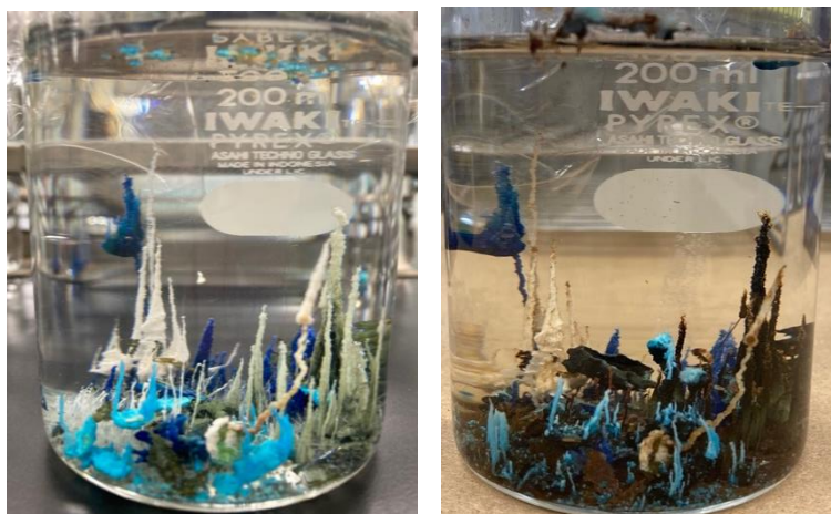
図 4 ビーカーで成長させたケイ酸膜(左: 観察 1 日目、右: 観察 3 日目。塩化鉄(II)および硫酸鉄のケイ酸膜のみ、3 日後に完全に茶色く変色した。)
