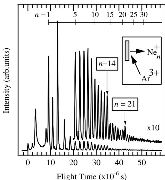
図3:  $\text{Ar}^{3+}$  入射により Ne 固体表面から脱離したイオンの飛行時間スペクトル。 $n$  は脱離した Ne クラスターイオンのサイズ。 $\text{Ar}^{3+}$  のエネルギーは 2.7keV。
