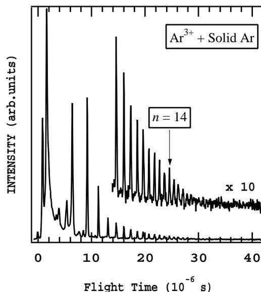
図4:  $\text{Ar}^{3+}$  入射により Ar 固体表面から脱離したイオンの飛行時間スペクトル。 $\text{Ar}^{3+}$  のエネルギーは 2.7keV。
